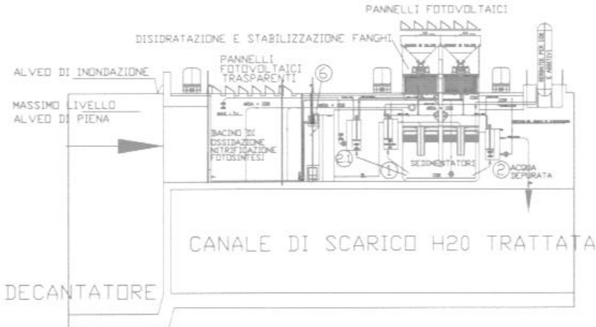
B) SCHEMA DI FLUSSO DEPURATORE-CARBONATORE-ALCALINIZZATORE FLUVIALE MODULARE CON RECUPERO E CONSUMO DI CO 2 E PRODUZIONE DI ENERGIA ELETTRICA SOLARE
